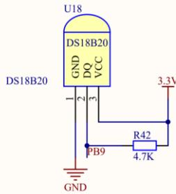
Fig. 3. The circuit diagram of the temperature sensor DS18B20.
